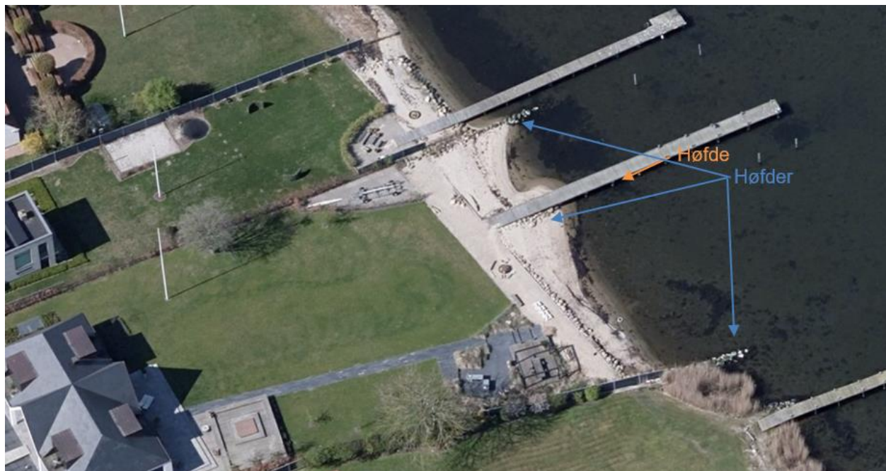
Figur 1, skråfoto af kystsikring på Stranden 7B. Blå pil peger på høfderne
